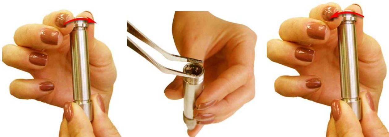
Рисунок 4. Замена защитного стекла объектива.
