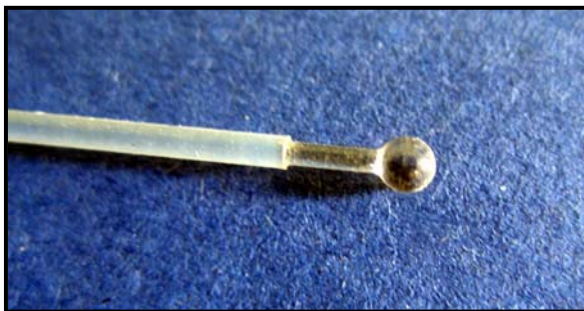
Рис.4. Увеличенное изображение микролинзы – «шарика» наконечника.
